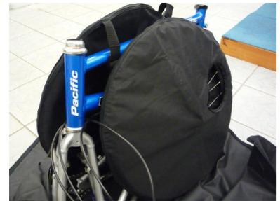
11 車手立管放入車架與後輪縫隙內
