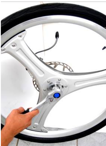
3.使用快速板手加上 20 號套筒將鐵蓋卸下。
