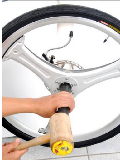
4.使用拆裝治具和木槌，敲打花鼓軸心，卸下前輪。
