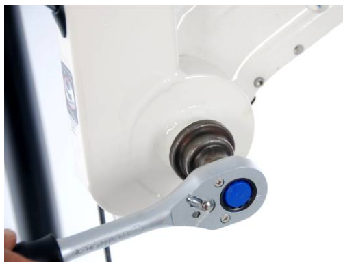
2.使用快速板手加上 14 號套筒扣住五通變速系統的左端。
