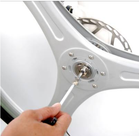
1.使用六角板手，將鐵盤與螺絲鬆開。
