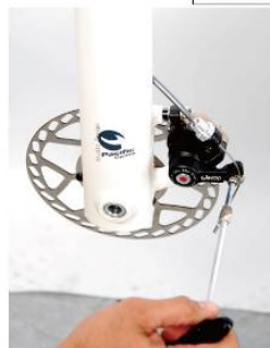
6.拆下剎車器上的兩個螺絲及兩個黑色墊圈。
