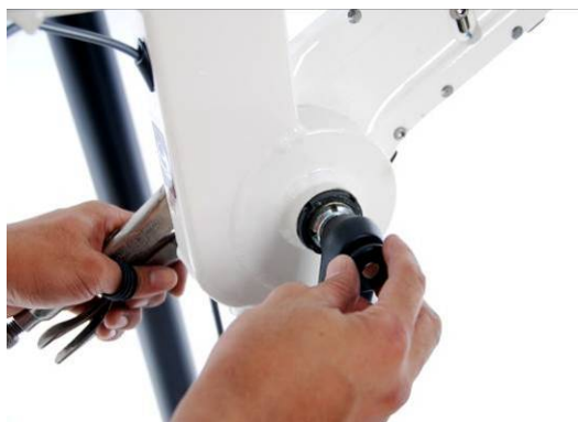
3.使用工具夾住五通變速系統的右端，然後固定左端，將右端旋開。
