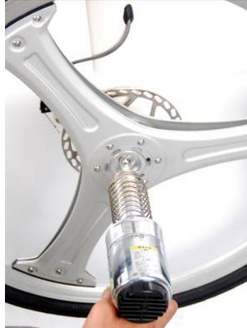
2.先使用吹風機將花鼓側蓋上的 Locktie 軟化。
