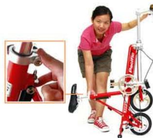
4 將座管快拆扣住車架上的黑色快拆扣。
