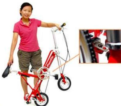
3 將座管背後的卡桿向上推，將座椅向前轉。拆開坐管上端的快拆把，將座椅向下推到底並向右轉避開立管。
