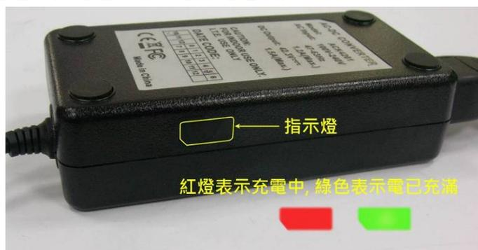
8. 完成充電後，請先拔起充電器電源插座端的接頭，接著才拔起與電池端連接的接頭。
