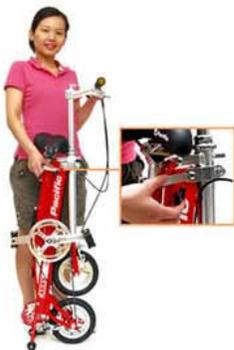
5 1. 拆開立管頂端的快拆把，將立管向下推到底並向左轉90度，關上快拆把。
